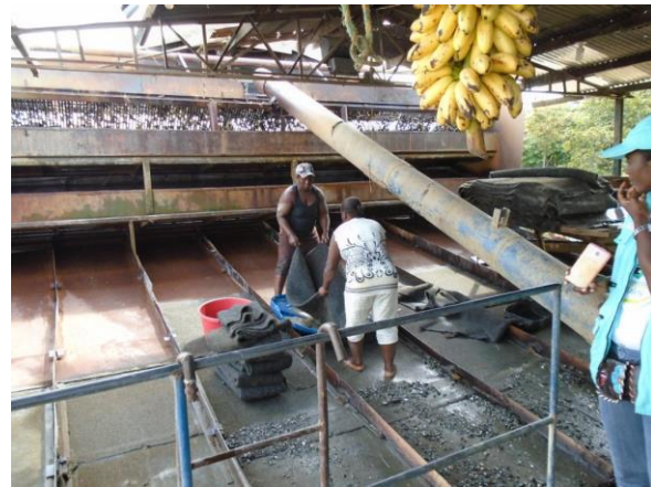
Foto 3. Canalon de aproximadamente 30 m por donde se transporta mecla de agua Substrato y oro
